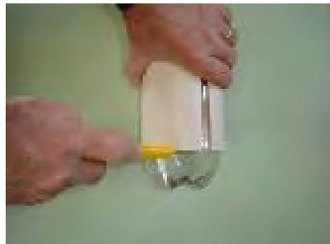
**Cortem as garrafas com o tamanho suficiente para ajustarem-se entre si, o que evitará a fuga do calor gerado e a entrada de umidade. As medidas dos tubos devem ser ajustadas para cada região, pois há diferença na altura das garrafas, já que são sopradas em matrizes que definem o mesmo volume, mas com perfil diferente. Mesmo as garrafas de Pepsi e de Coca há diferentes tamanhos por região, em razão das matrizes onde são sopradas.**
