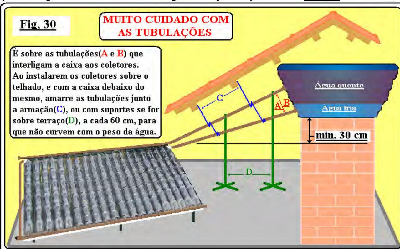
Ao darmos a preferência pelo sistema de circulação por termo sifão, torna-se obrigatório que o fundo da caixa fique sempre acima da parte superior do coletor solar, ou seja, mínimo de 30 cm e máximo 3 m, (**Pág. 6, It. 2.1- Circulação por termo sifão**).
