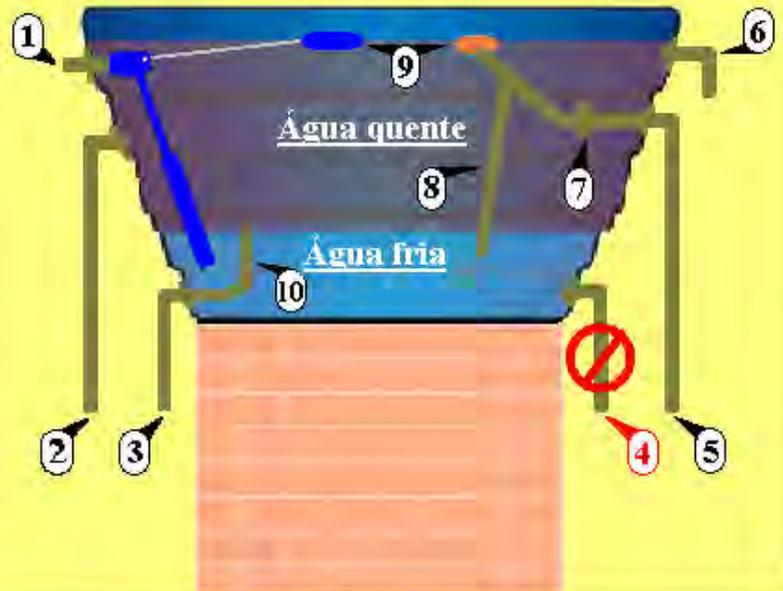
Na **Fig.14**, é possível visualizarmos toda instalação da caixa d'água e a função de cada item, faltando apenas o redutor de turbulência.
